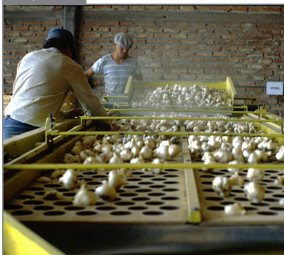
Calibradoras de bulbos. Izquierda “de golpe”. Derecha “de malla”. Fuente: J.L. Burba.
